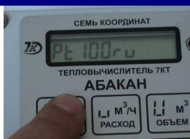
держат кнопку 5сек, проверить тип термодатчика
