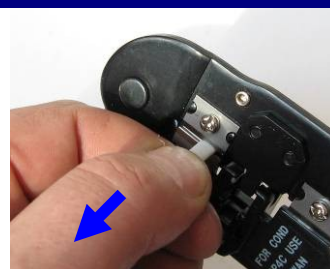
вставить до упора, снять изоляцию
